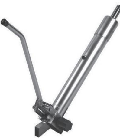
Hydraulischer Pumpenzylinder für Autotransportanhänger<br>Länge 537mm, Hub 300mm, Sicherheitsauslöser mit Überdruckventil<br>zum Heben und Senken von Lasten bis 2to, Wartungsfreies<br>geschlossenes Hydrauliksystem | 16,60      | 407696.001    |
