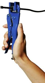
Mit Stufe 1 der Montagezange „Aspöck“ bis zum Anschlag pressen.
