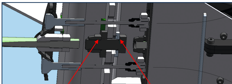
nakrętka zabezpieczająca M12 moment dokręcania 80 +10 Nm
