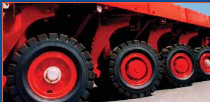
Im Einsatz längst bewährt: Knott Pendelachse mit Scheibenbremse
